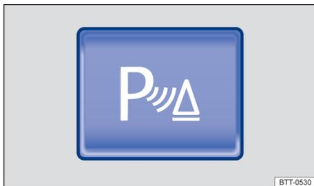
**Fig. 102** En la radio: conectar y desconectar la ayuda de aparcamiento.
