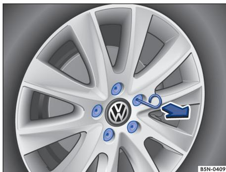
**Fig. 163** Retirar las caperuzas de los tornillos de la rueda.
