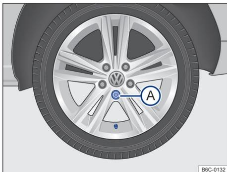
Fig. 164 Retire el tapacubos integral.
