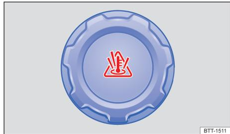
Fig. 151 En el compartimento del motor: tapa del depósito de expansión del líquido refrigerante del motor.
