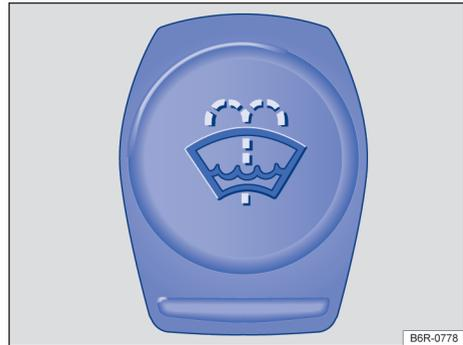
**Fig. 147** En el compartimento del motor: tapón de cierre del depósito de agua de los lavacristales.
