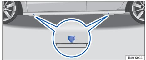
**Fig. 161** Puntos de apoyo del gato.
