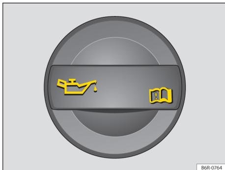
Fig. 149 En el compartimento del motor: tapón de la boca de llenado del aceite del motor.
