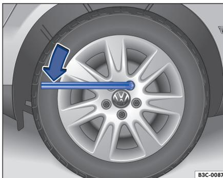
**Fig. 160** Cambio de rueda: aflojar los tornillos de la rueda.
