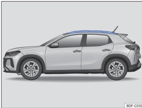
**Fig. 124** Soportes longitudinales del maleteros de techo (ambos lados).
