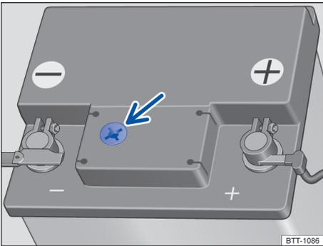
**Fig. 153** En el compartimento del motor: ejemplo de posición del visor en el lado superior de la batería del vehículo.
