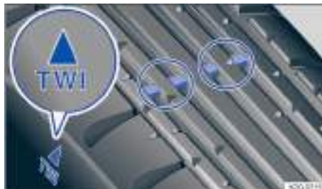
Fig. 199 Perfil del neumático: indicadores de desgaste.
