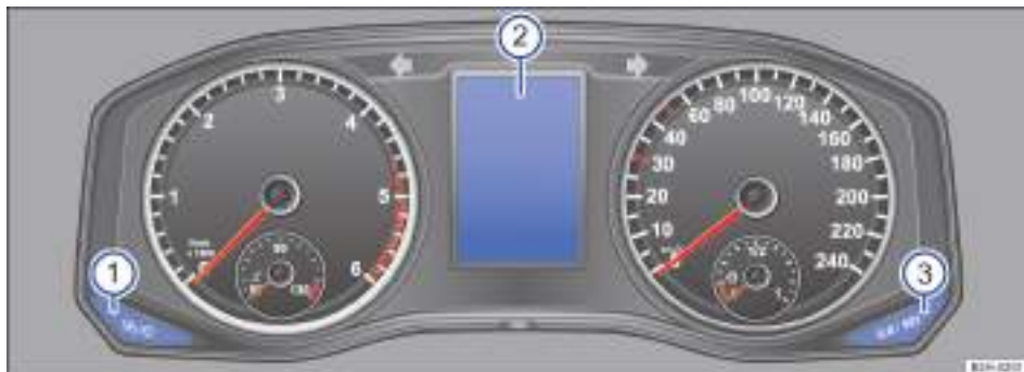
Fig. 195 Teclas del cuadro de instrumentos, en el tablero de instrumentos.
