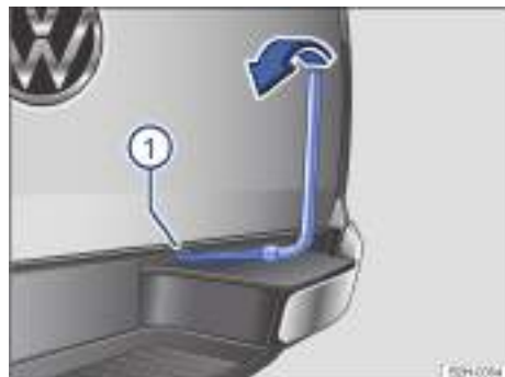
Fig. 211 Colocar la rueda de repuesto sobre el cabrestante.
