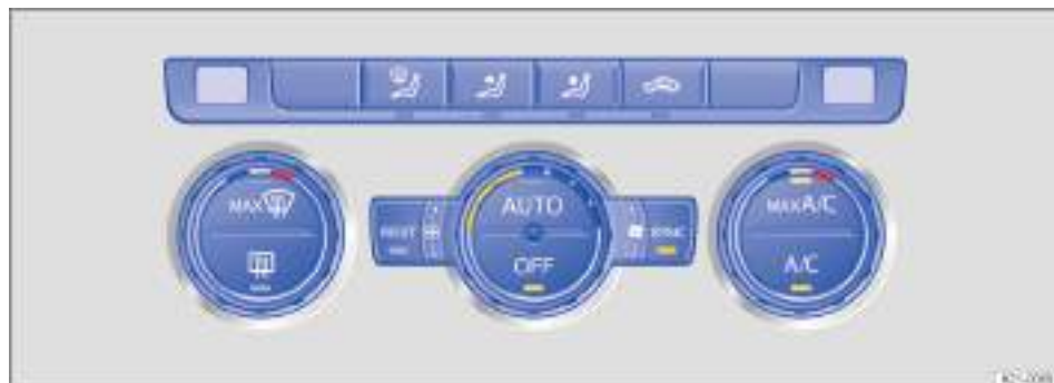
Fig. 97 En el tablero de instrumentos: mandos del Climatronic.
