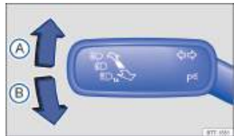
Fig. 84 A la izquierda en la columna de dirección: palanca de los intermitentes y de la luz de carretera.
