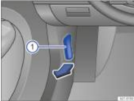
Fig. 180 En la zona reposapiés a la izquierda: palanca de desbloqueo del capó delantero (representación gráfica)
