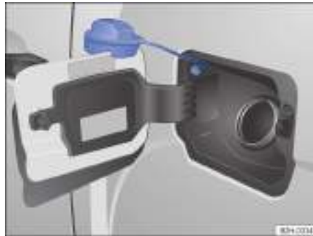
Fig. 150 En el lado izquierdo del vehículo: tapa del depósito de combustible con el tapón abierto.
