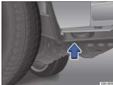
Fig. 214 Desde el lateral: punto de apoyo para el gato en la parte delantera.
