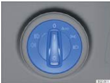
Fig. 82 Junto al volante: mando de las luces (una variante).
