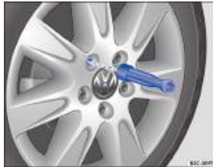
Fig. 219 Cambiar una rueda: desenroscar los tornillos de rueda con el mango del destornillador.
