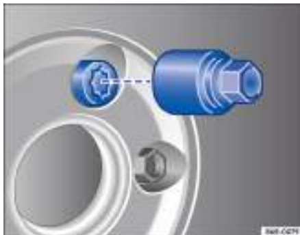
Fig. 203 Cambiar una rueda: tornillo de rueda antirrobo y adaptador.
