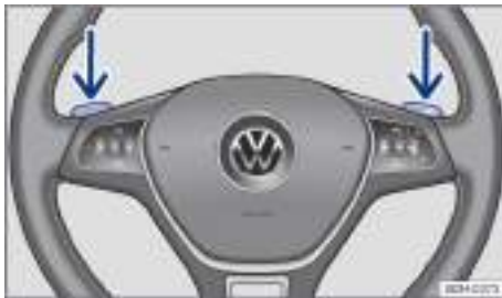
Fig. 105 Volante con conmutadores basculantes del Tiptronic.
