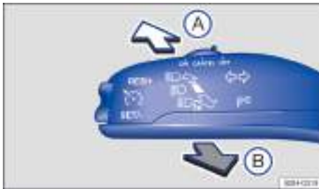
Fig. 83 En el lado izquierdo de la columna de dirección: palanca de los intermitentes y de la luz de carretera.
