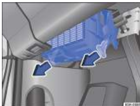
Fig. 169 Caja de fusibles debajo del tablero de instrumentos.
