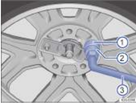
Fig. 206 Desmontar el dispositivo antirrobo.
