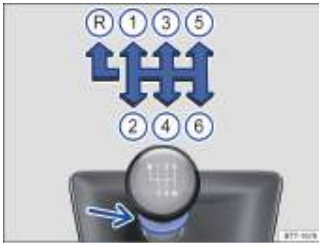
Fig. 102 Esquema de las marchas de un cambio manual de 6 marchas.
