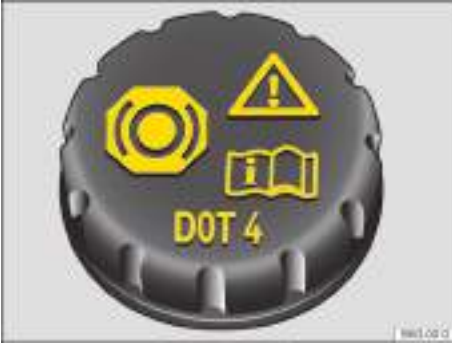
Fig. 192 En el vano motor: tapa del depósito del líquido de frenos.
