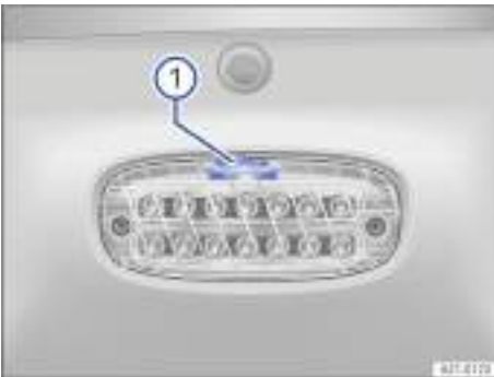
Fig. 88 Encima de la compuerta de carga: mando de la luz del techo rígido.
