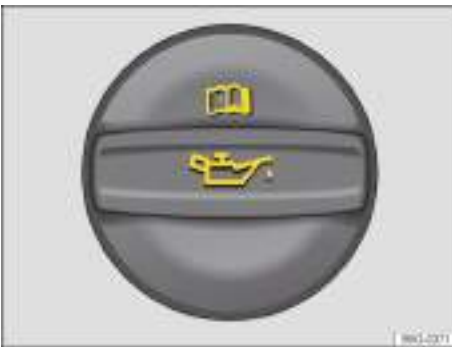
Fig. 188 En el vano motor: tapa de la boca de llenado de aceite del motor (representación esquemática).
