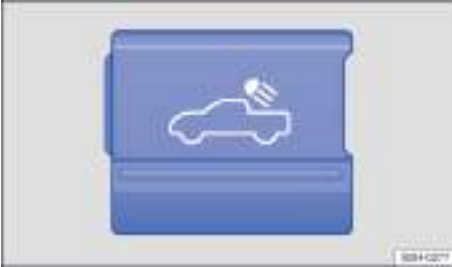
Fig. 87 En la consola central: tecla de la luz de la superficie de carga.
