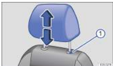
Fig. 74 En el asiento delantero: Ajustar el apoyacabezas (variante 2).
