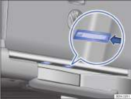
Fig. 165 En la chapa de cierre trasera, debajo de la compuerta de carga: luces de matrícula.
