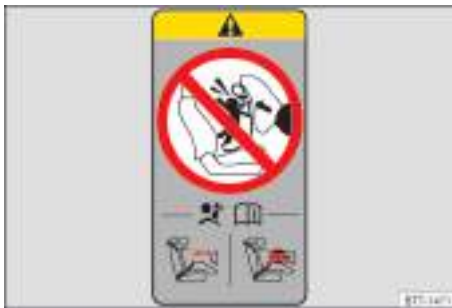
Fig. 49 Representación esquemática: etiqueta adhesiva relativa al airbag en el pilar B.
