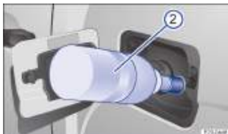
Fig. 153 Cargar AdBlue con una botella de recarga.
