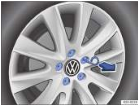
Fig. 201 Retirar las caperuzas de los tornillos de la rueda.
