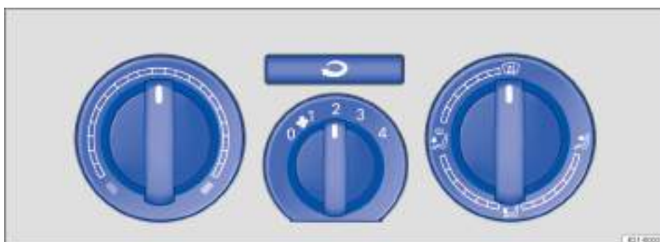
Fig. 95 En el tablero de instrumentos: mandos del sistema de calefacción y ventilación.
