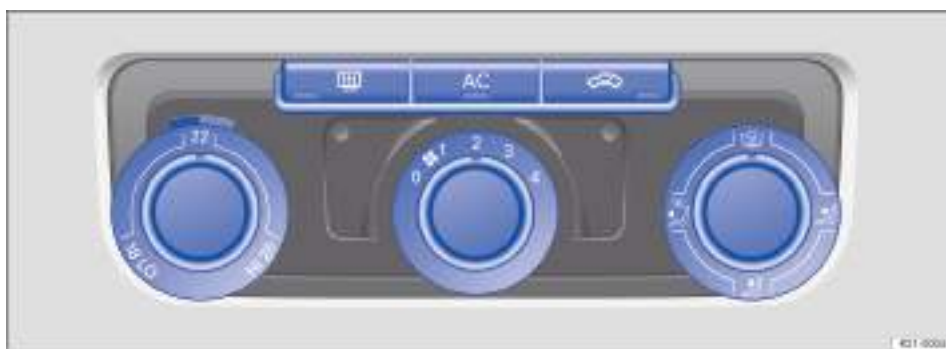
Fig. 96 En el tablero de instrumentos: mandos del Climatic.
