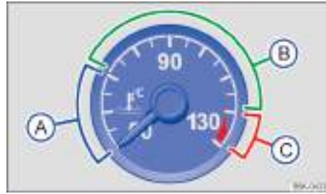
Fig. 14 Indicador de temperatura del líquido refrigerante del motor en el cuadro de instrumentos analógico (representación esquemática).
