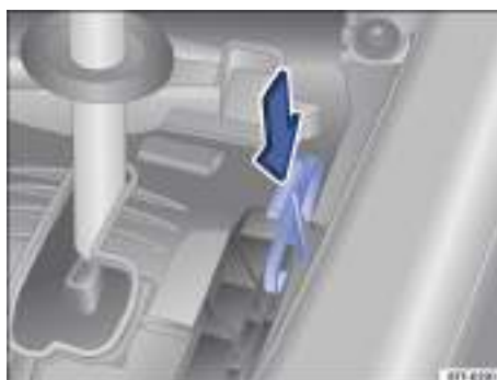
Fig. 107 Desbloqueo de emergencia de la palanca selectora.
