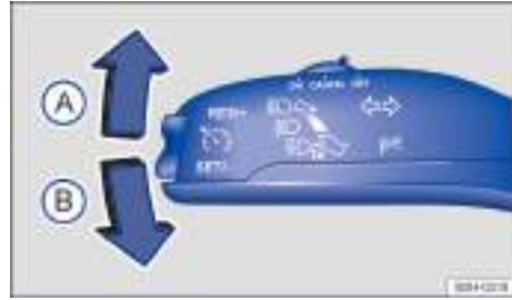
Fig. 81 En el lado izquierdo de la columna de dirección: palanca de los intermitentes y de la luz de carretera.
