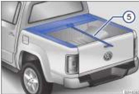
Fig. 64 Capota marítima de la zona de carga: cinta tensora
