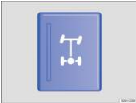
Fig. 112 En la consola central: tecla del bloqueo del diferencial (representación esquemática).
