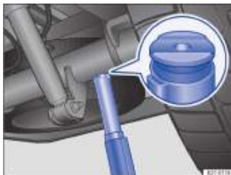
Fig. 218 Colocar el gato debajo del eje trasero.
