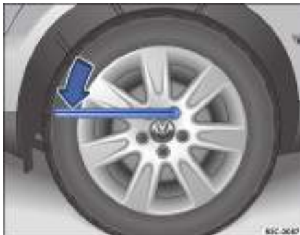
Fig. 202 Cambiar una rueda: aflojar los tornillos.
