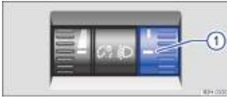
Fig. 85 Junto al volante: regulador del alcance de las luces ①.
