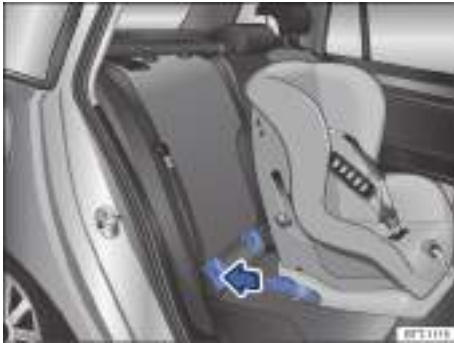
Fig. 51 Representación gráfica: montar asiento para niños con ISOFIX con los brazos de apoyo.
