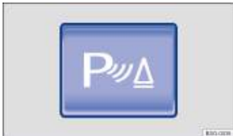
Fig. 119 En la consola central: tecla para conectar y desconectar la ayuda de aparcamiento (en función del equipamiento).
