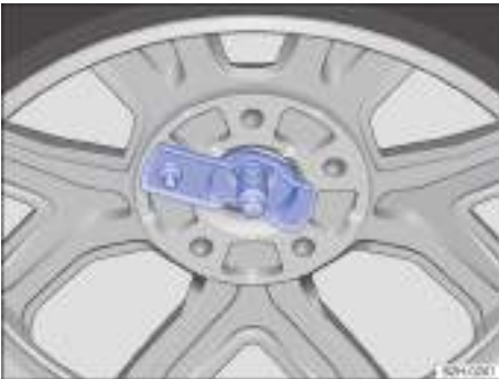
Fig. 209 Rueda de repuesto o de emergencia: colocación correcta de la placa de apoyo de la llanta en el orificio de la llanta.
