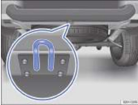
Fig. 176 Abajo del paragolpes: argolla de remolque en vehículos sin dispositivo de remolque de fábrica.
