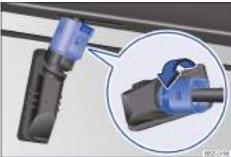
Fig. 166 Luz de matrícula: desmontaje del portalámparas.
