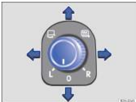
Fig. 93 En la puerta del conductor: mando giratorio de los retrovisores exteriores.
