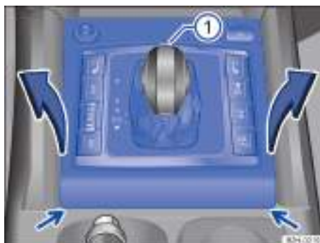
Fig. 106 Desmontar la cubierta de la corredera de la palanca selectora.
