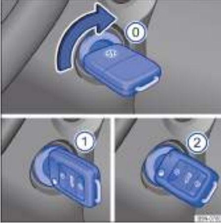
Fig. 101 Junto al volante, en el lado derecho: posiciones de la llave del vehículo en la cerradura de encendido.
