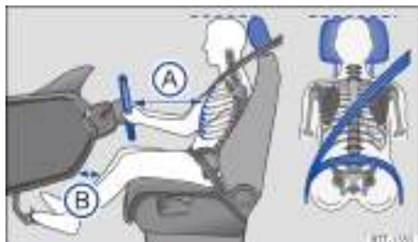
Fig. 28 Representación esquemática: distancia correcta entre el conductor y el volante, colocación correcta de la banda del cinturón y ajuste correcto del apoyacabezas.
