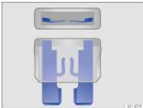
Fig. 171 Fusible fundido (representación esquemática).
