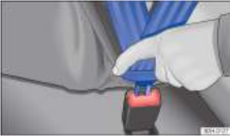
Fig. 35 Insertar la lengüeta del cinturón de seguridad en su cierre.
