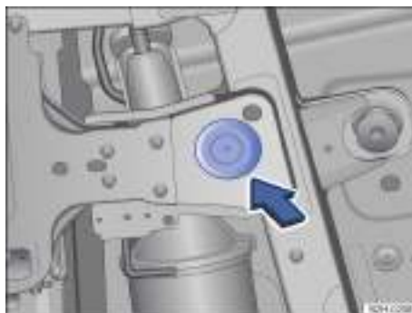
Fig. 215 Desde abajo: punto de apoyo para el gato en la parte delantera.
