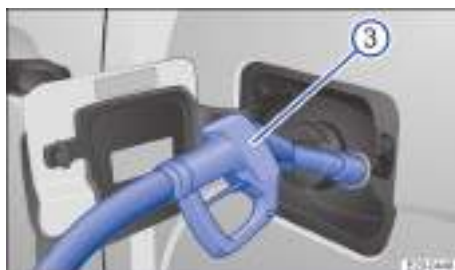
Fig. 154 Repostar AdBlue con la pistola de un surtidor.
