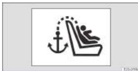
Fig. 54 Representación esquemática: distintivo del punto de fijación del cinturón Top Tether.
