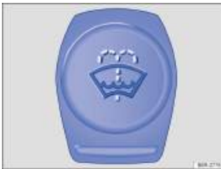
Fig. 184 En el vano motor: tapa del depósito del líquido limpiaparabrisas.
