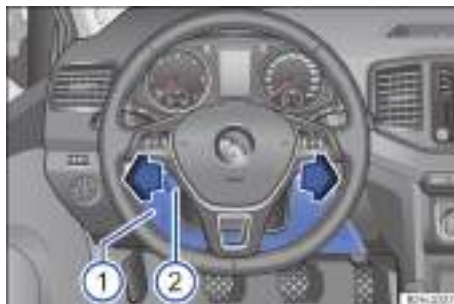
Fig. 170 En el lado del conductor, vehículos con el volante a la izquierda: caja de fusibles detrás del guanrecido del tablero de instrumentos.
