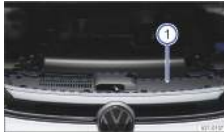
Fig. 186 Ubicación del adhesivo con la norma y la viscosidad del aceite del motor (representación esquemática).
