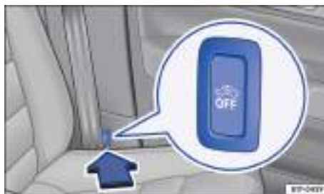
Fig. 60 Junto al asiento del conductor: tecla para desconectar la vigilancia del habitáculo y el sistema antirremolcado.
