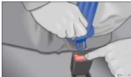
Fig. 34 Soltar la lengüeta del cierre del cinturón.
