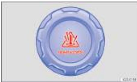
Fig. 189 En el vano motor: tapa del depósito de expansión del líquido refrigerante del motor.
