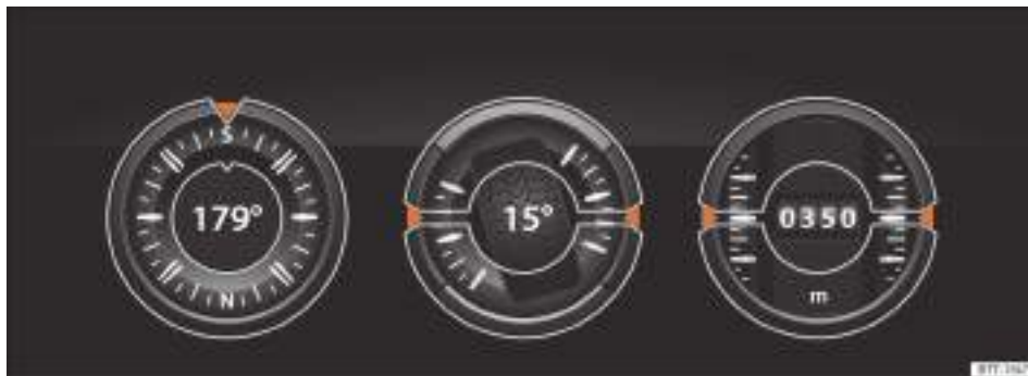
Fig. 110 En el sistema de infotainment: indicador Offroad.
