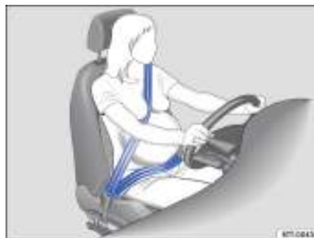
Fig. 38 Colocación correcta de la banda del cinturón en las mujeres embarazadas.
