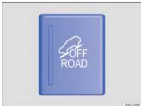
Fig. 108 En la consola central: tecla para conectar y desconectar manualmente la función Offroad.
