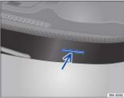
Fig. 222 En el parabrisas: número de identificación del vehículo.
